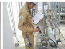
▲ガス検知器による井周り点検 (事後対応)
